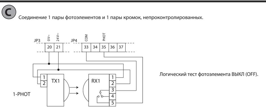
**C** Соединение 1 пары фотоэлементов и 1 пары кромок, непроконтролируемых.
