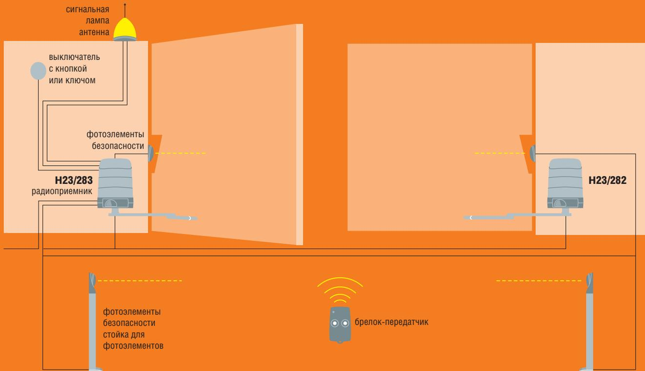
Оптимальный привод для автоматизации приусадебных ворот, установленных на широких колоннах. Для открывания створки на угол 90° необходимо всего 12 секунд, что является одним из лучших значений времени в сравнении с аналогичными конкурирующими моделями.
