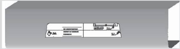
Используйте трафарет при сверлении отверстий для крепежа
