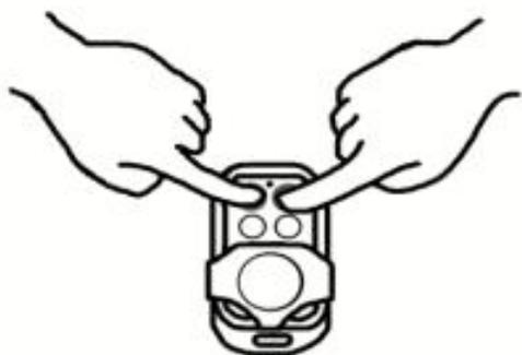
1. Для ввода в режим программирования, одновременно нажать и удерживать нажатыми в течении 3 сек кнопки А и В. Светодиод быстро моргнет 3 раза.
