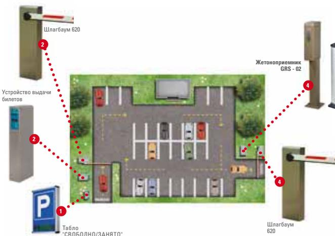
**PARKLITE STANDARD TAG:** обслуживание непостоянных клиентов и абонентов без использования компьютера и программного обеспечения.
