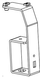
**Крепление ручки разблокировки привода для версии H= 205 (требуется только для дверей, не имеющих крышки несущего короба)**
