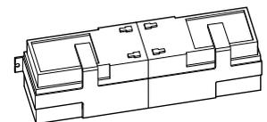
**Аккумуляторы аварийного питания с платой контроля заряда SM для версии H=180 (30 мин. автономной работы при интенсивности использования двери 100%)**
