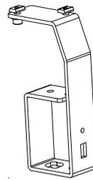
**Крепление ручки разблокировки привода для версии H= 180 (требуется только для дверей без крышки несущего короба)**
