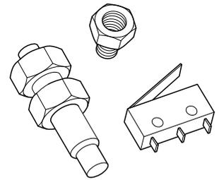
**Устройство контроля состояния электромеханического замка привода и положения створки**
