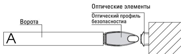
**Рис. С - Монтаж на стойку SAFEBEAM**
