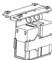
**Аккумуляторы аварийного питания с платой контроля заряда SM для версии H=205 (30 мин. автономной работы при интенсивности использования двери 100%)**
