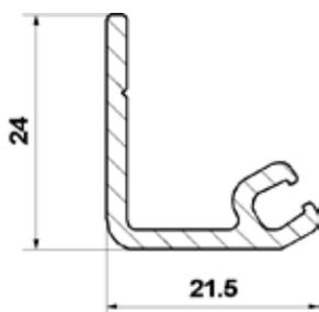
**Закрывающий профиль из необработанного алюминия (рейка 3 м)**
