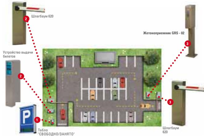
**PARKLITE STANDARD:** обслуживание только непостоянных и разовых клиентов без использования компьютера и программного обеспечения.
