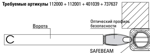
**Рис. В - Монтаж с противоударным профилем**
