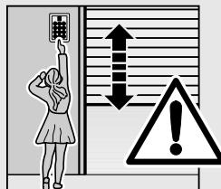
**Instalowane na stałe urządzenia sterujące (sterowniki itp.) należy montować w miejscu umożliwiającym obserwację bramy, ale oddalonym od jej elementów ruchomych. Instalację należy wykonać na wysokości co najmniej 1,5 m, w miejscu niedostępnym dla dzieci!**
