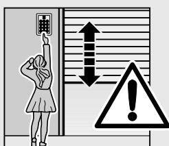
**A fixen rögzített vezérlő egységek (mint pl. nyomógomb) a kapu látótávolságába legyenek elhelyezve, de a mozgó részektől megfelelő távolságra. Feltétlenül gyerekek számára nem elérhető, min. 1,5 m magasságban legyenek elhelyezve!**
