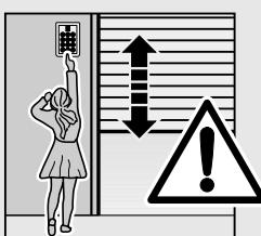
**Pevně instalované ovládací přístroje (jako tlačítka apod.) je třeba namontovat v dohledu vrat, ale mimo pohybujících se dílů. Musí se bezpodmínečně umístit mimo dosah dětí ve výšce minimálně 1,5 m!**
