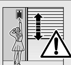
**Aparalele de comandă instalate fix (precum tasterele sau altele asemenea) trebuie montate în aria vizuală a porții, dar la distanță față de elementele mobile. Acestea trebuie fixate neapărat în afara accesului copiilor, la o înălțime de minimum 1,5 metri!**
