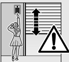
**Fiksno instalirani upravljački uređaji (kao tipkala i sl.) moraju se montirati u horizontalnoj vidljivosti vrata, ali udaljeni ud pokretnih dijelova. Oni se obavezno moraju postaviti izvan dosega djece, na visini od najmanje 1,5 m!**
