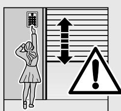
**Fiksno vgrajene naprave krmiljenja** (kot so tipkala itd.), morajo biti montirane v vidnem polju vrat, vendar v primerni oddaljenosti od gibljivih delov in najmanj na višini 1,5 m!
