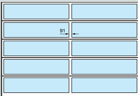
Вариант исполнения ворот с шириной больше 3330 мм с вертикальной балкой
